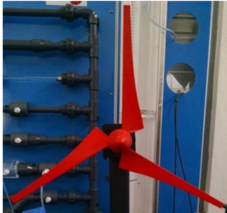
Rotor de 25 W fabricado en plástico ABS empleando tecnología de impresión 3D.
