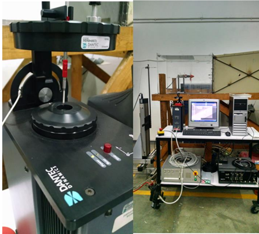
Anemómetro de hilo caliente incluyendo sistema de posicionamiento (derecha) y equipo de calibración de
